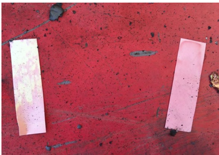
Figuur 22 Fluoride testpapier na experiment C op de vloer op +/- 1 m van de brandlocatie. Beide testpapiertjes zijn aan gelijke hoeveelheden fluoride blootgesteld. Het linker papier is volgens gebruikshandleiding aangezuurd met 0,1M HCl oplossing en het rechter papier is alleen bevochtigd met demi water. Ondanks de aanwezigheid van lithiumhydroxide (vloer = pH 9 - 10) verkleurt het aangezuurde fluoride testpapier nog goed. Bevochtigen met alleen demi water kan bij depositiemetingen een vals negatieve uitslag geven.
