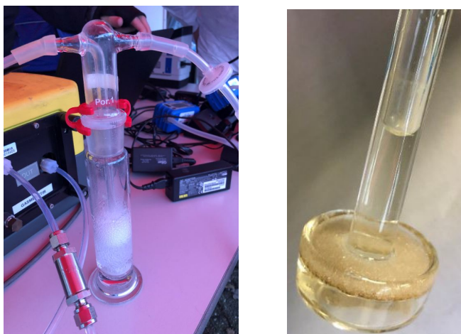
Figuur 3 Toegepaste impingers bij de brandexperimenten. Rechts het fritje wat bij experiment B en D snel verstopt raakte door een vettige substantie van de rook.
