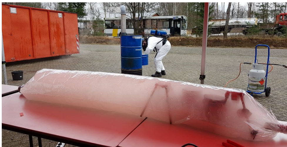
Figuur 2 Gevulde nalofaan rookzak met daarin balaclava 's en objectglasjes, links de vulopening en rechts de monstername punten voor rookgasanalyse.
