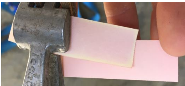
Figuur 31 Fluoride testpapier dat enkele minuten is blootgesteld aan rook met fluorwaterstof concentraties in orde van 2 - 5 ppm. Het fluoride testpapier is niet vooraf behandeld met water of een HCl oplossing.
