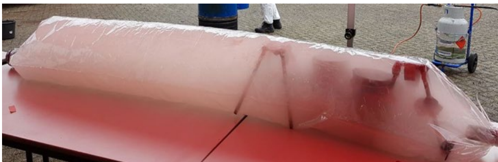
Figuur 13 Locaties van veegmonsters aan de binnenzijde van de zak na het experiment. Rood zijn de metalen en groen de fluorwaterstof swabs.
