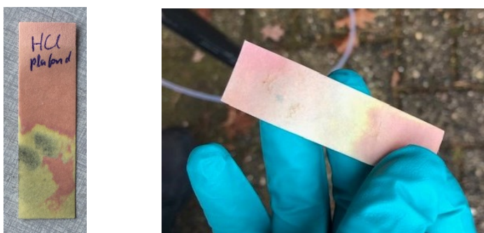
Figuur 26 Links fluoridepapier na brandexperiment in mei 2019 in ruimte van 4,4m 3 . Rechts fluoridepapier na contact binnenzijde zak experiment B van het hoofdreportage. Het fluoride gehalte lijkt op het rechter papier lager.
