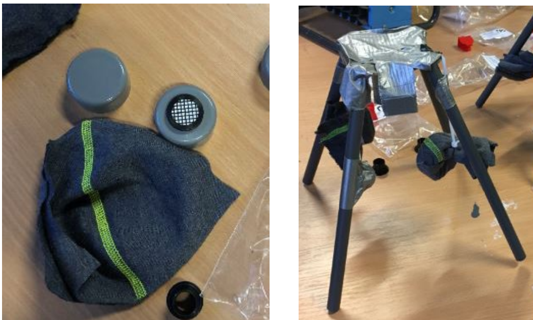
Figuur 15 Stukken balaclava 's worden om het HF filter gevouwen en onder een statief gehangen om wandcontact met de zak te voorkomen. De balaclava is niet in direct contact met de stof gekomen door het rooster voor het filter.
