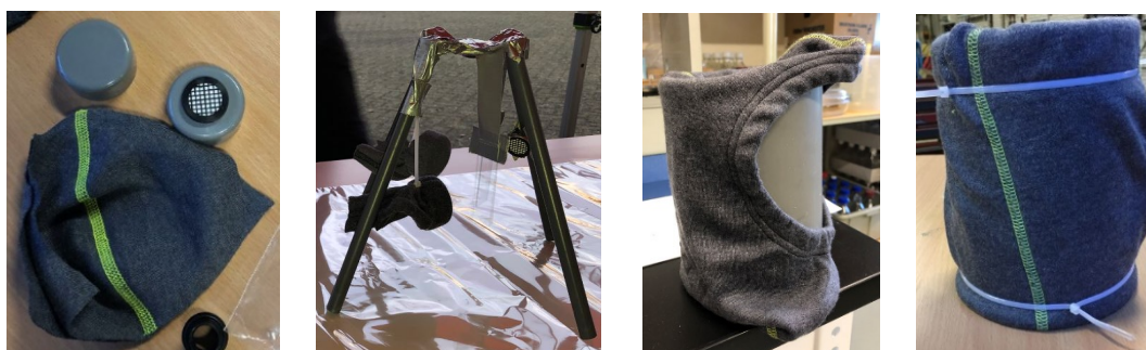
Figuur 5 Van links naar rechts: Balaclava en HF filter op PVC dop. Statief met daaronder met droge, natte en onbeschermdde HF filters. Balaclava om PVC buis, en Balaclava om PVC buis klaar voor test.
